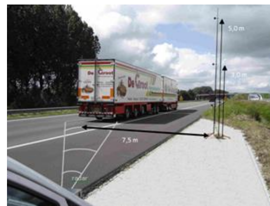
figuur 2 Meetopstelling volgens de SPB-methode
