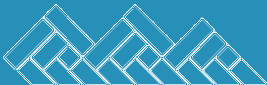
Keperverband gelegd met keper- en L-steen
